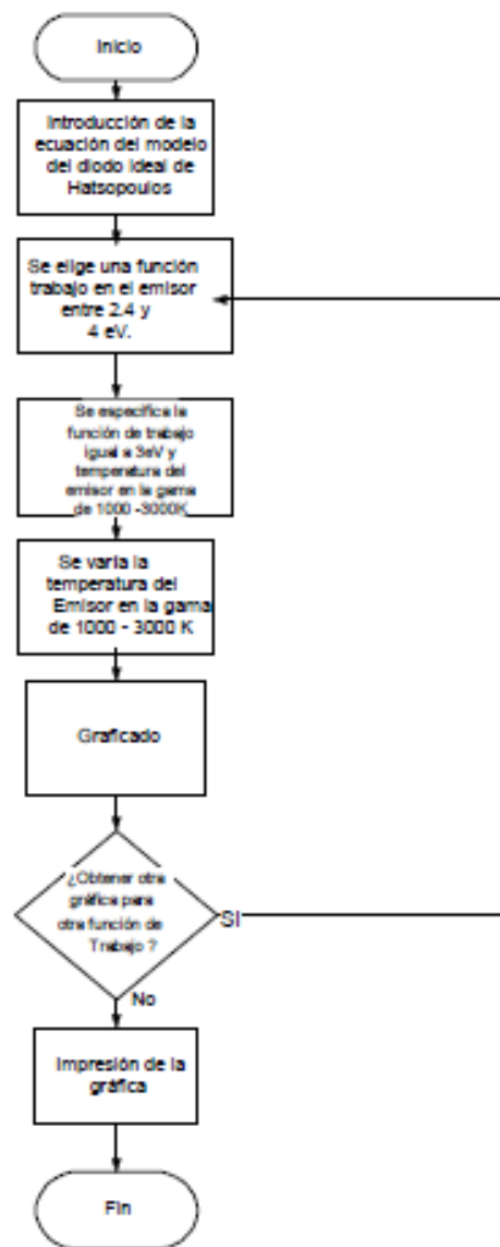
Fig. 2.2 Diagrama de flujo para calcular la emisión de los electrones en un diodo termoiónico para cuando se varía la temperatura del emisor
